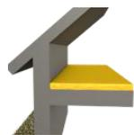
**Ajout d'une isolation sur le plancher des combles perdus : 280 mm de laine minérale soufflée R = 7.0 m<sup>2</sup>.K/W**
