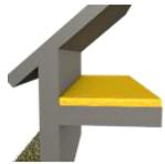
**Ajout d'une isolation sur le plancher des combles perdus : 320 mm de laine minérale soufflée R = 8.0 m<sup>2</sup>.K/W**
